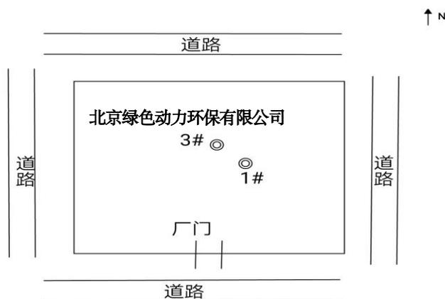
说明：◎ 焚烧炉废气采样点
